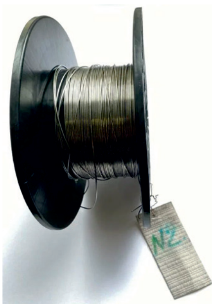
Рис. 1. Полученная проволока диаметром 1 мм
