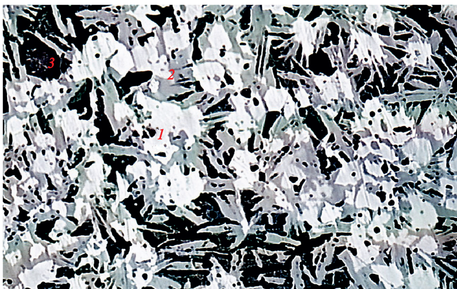
Рис. 3. Ферритная связка в составе высокоофлюсованных агломератов: 1 – магнетит, 2 – феррит, 3 – стеклофаза. Отраженный свет, \times 200
