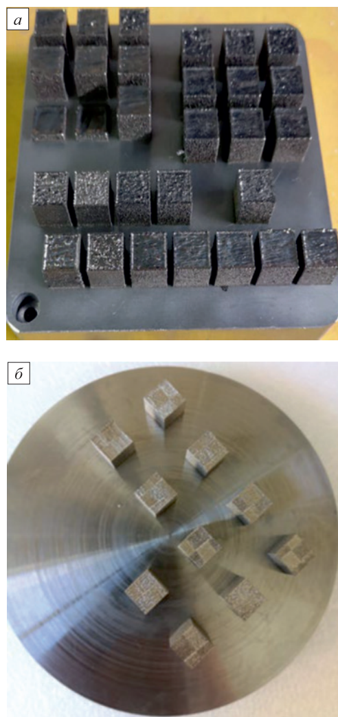
Рис. 1. Внешний вид экспериментальных образцов, синтезированных на установках SLM 280HL (а) и TruPrint 1000 (б)
