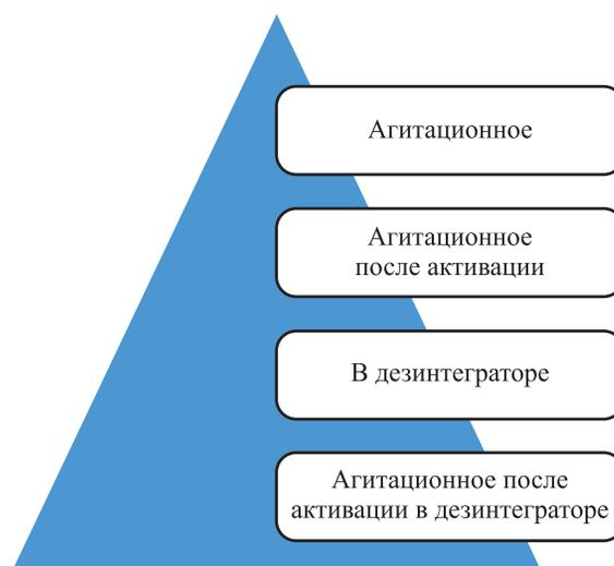
Рис. 2. Способы извлечения металлов из хвостов обогащения
