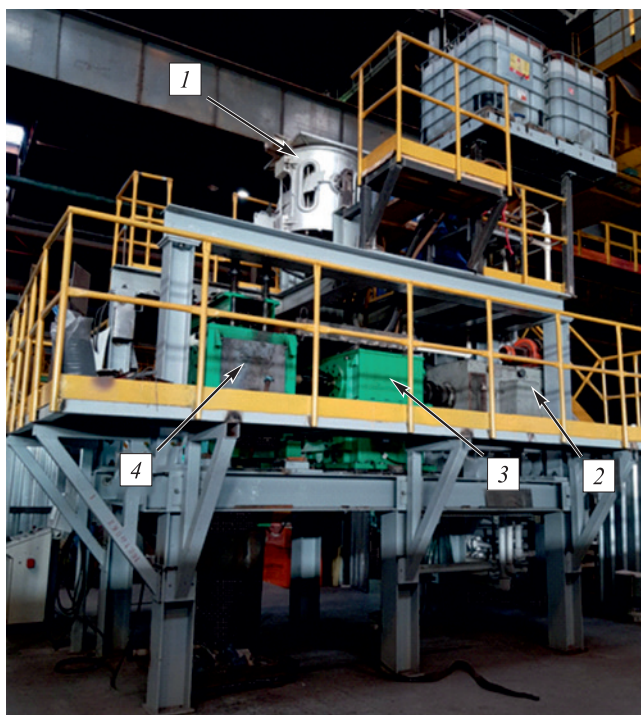
Рис. 2. Установка непрерывного литья и деформации: 1 – индукционная печь; 2 – электродвигатель постоянного тока; 3 – редуктор-синхронизатор; 4 – станина установки
