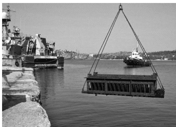
Рис. 3. Натурные испытания при погружении образцов в морскую воду с использованием кассеты
