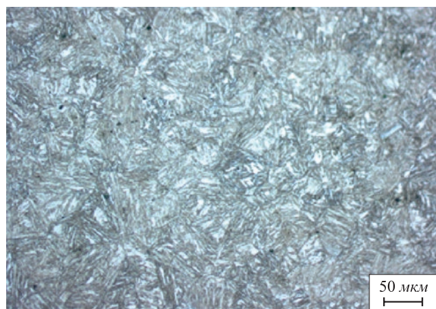
Рис. 5. Структура металла участка перегрева ЗТВ (бейнит – мартенсит) стали MAGSTRONG W700
