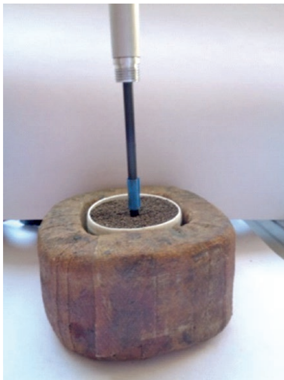
Рис. 1. Измерение индукции B_{ic} в центре образца дроби
