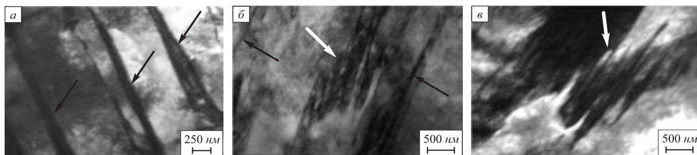
Рис. 3. Электронно-микроскопическое изображение выделений остаточного аустенита в пакетном (а), пластинчатом низкотемпературном (б) и высокотемпературном (в) мартенсите (черными стрелками отмечены прослойки \gamma -фазы по границам реек и пластин, белой стрелкой – внутри пластин)
