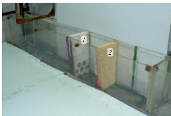
Рис. 2. Общий вид модели промежуточного ковша с разделительной перегородкой с пятью отверстиями (1) и вертикальным пенокерамическим фильтром (2)
