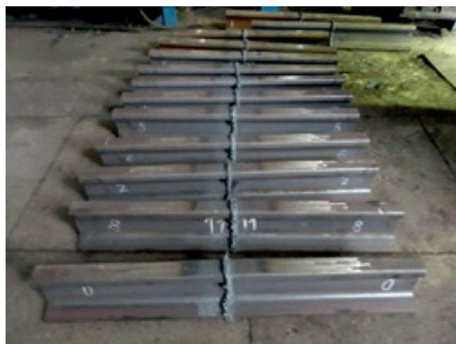
Рис. 2. Общий вид полнопрофильных образцов после сварки
