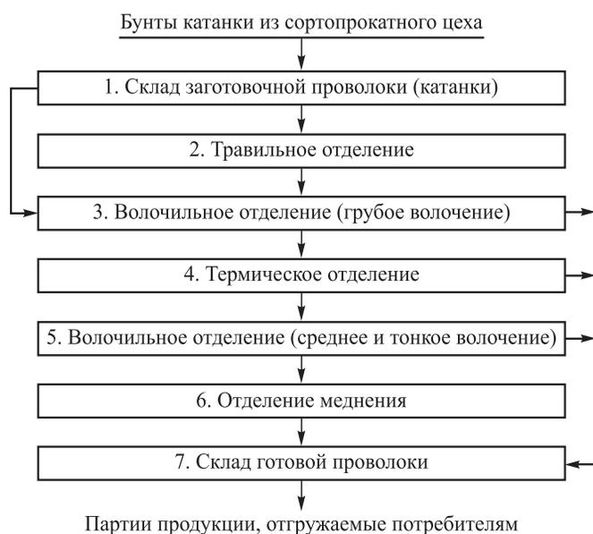
Схема технологических маршрутов сталепроволочного цеха
