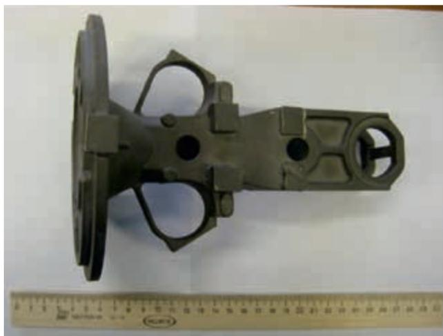
Рис. 4. Отливка «Вилка»
