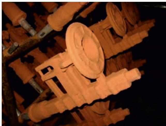
Рис. 3. Модельный блок отливок «Вилка»
