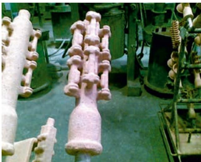
Рис. 1. Модельный блок ЛВМ
