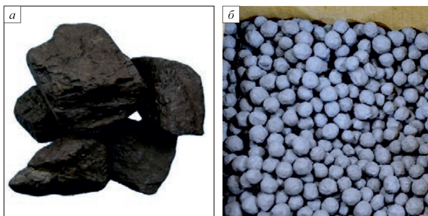
Рис. 1. Шихтовые материалы для выплавки АХС: высокозольный борлинский уголь (а); окатыши хромовой руды (б)
