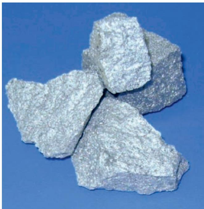
Рис. 1. Сплав алюмосиликомарганец
