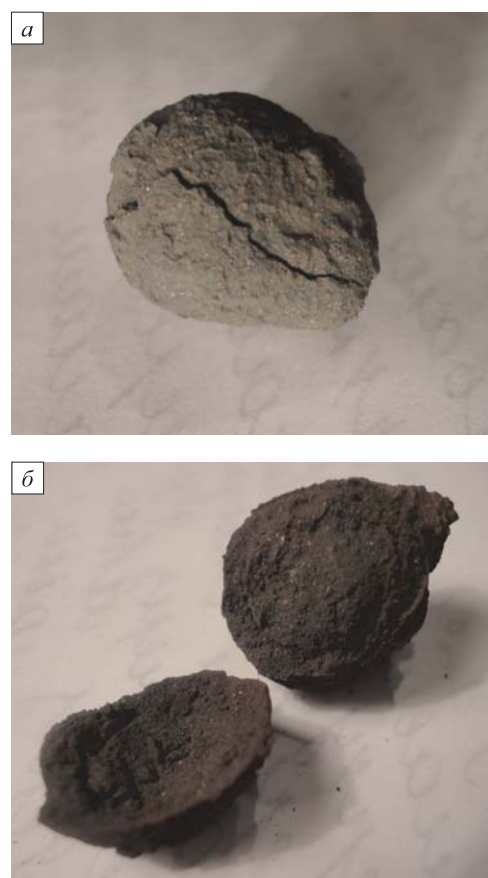
Рис. 3. Внешний вид окатышей, подвергнутых термическому разрушению:
